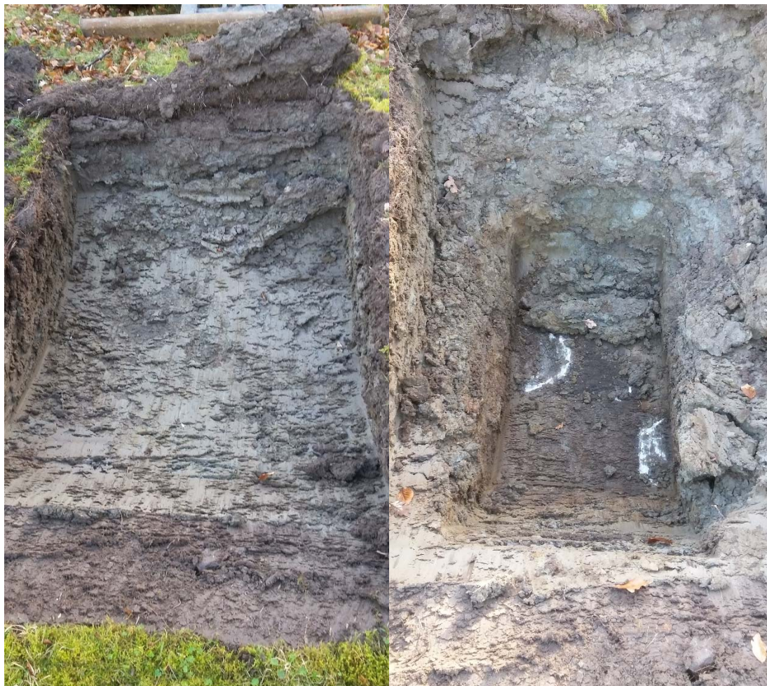
Figur 2: Provgrop GA02. Till vänster: yttig lera. Till höger: Skiktet med krossten som förhindrade djupare schakt.
